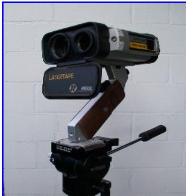
Photo des neuen Laser-Gerät zur Geschwindigkeitsmessungen von Wasserfahrzeugen
