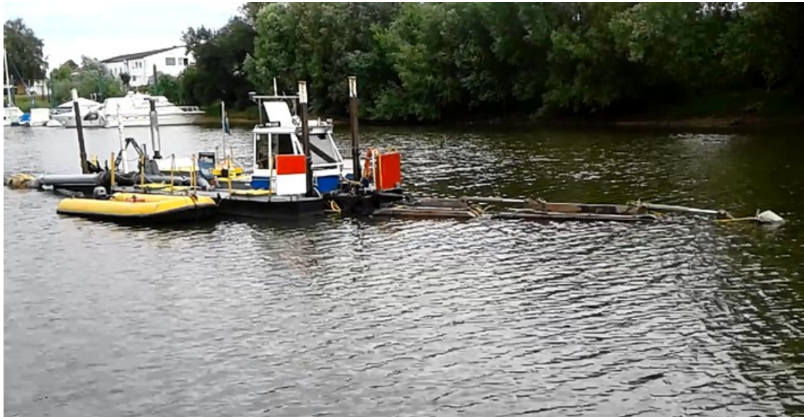
(Probeentschlammung im Altrhein – Saugbagger im Einsatz) © Foto: W. Reuters
